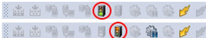
**Рис. 2.48 – Кнопки «Stop Resource(s)» (сверху) и «Start Resource(s)» (снизу) панели инструментов «Target Execution»**
