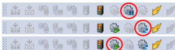
**Рис. 2.49 – Кнопки «Cycle-to-Cycle Mode» (сверху), «One Cycle» (в центре) и «Real Time Mode» (снизу) панели инструментов «Target Execution»**
