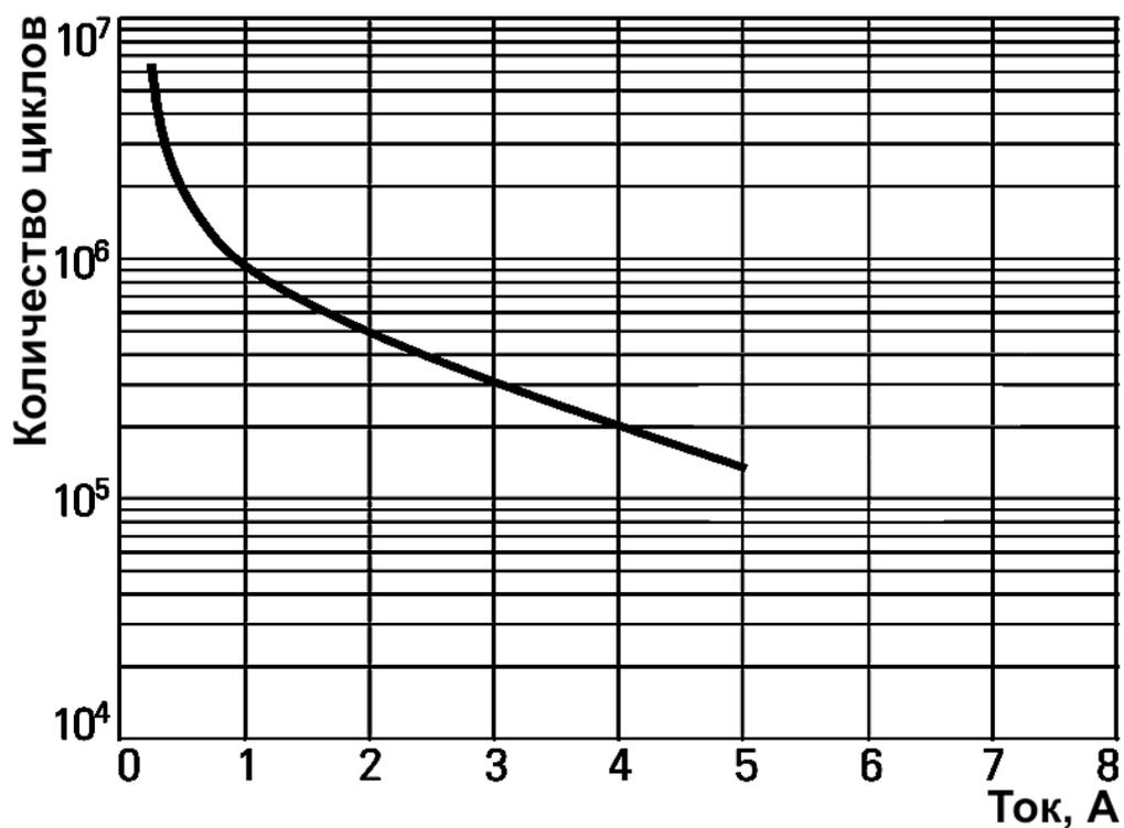
Рис. 2 – График количества циклов коммутации
