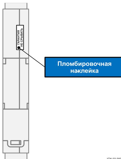
**Рис. 11 – Место установки пломбировочной наклейки**
