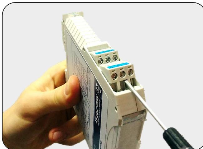
Рис. 4 – Отсоединение клеммной колодки
