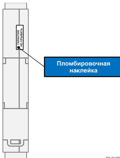
**Рис. 8 – Место установки пломбировочной наклейки**
