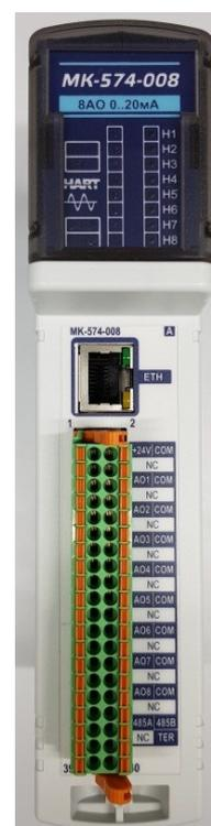
б) модуль аналогового вывода МК-574-008 А с разъемом Ethernet.
