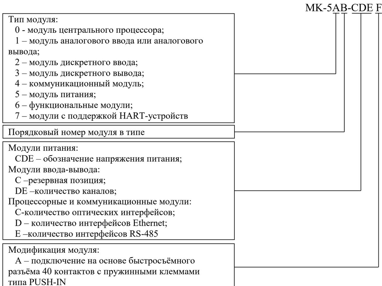
Рисунок 1 – Расшифровка условного обозначения модулей изделия.
