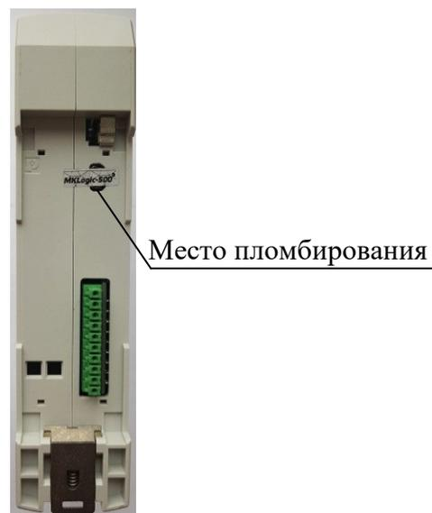
а) Внешний вид контроллеров; б) Схема пломбирования от несанкционированного доступа.
