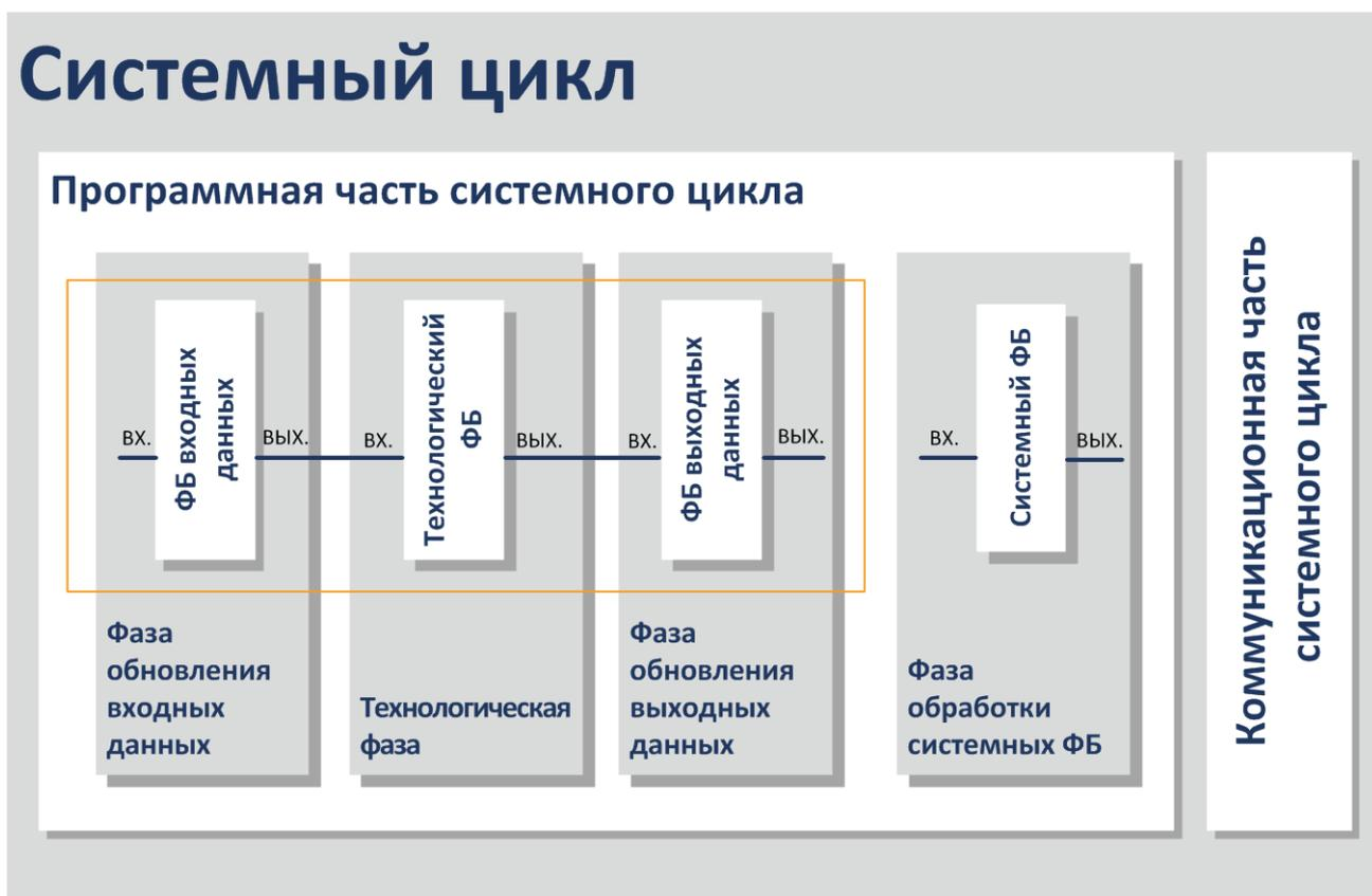
Рисунок 3. Системный цикл
